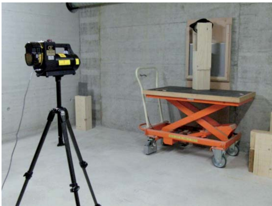
Mobile Röntgenblitzröhre im Labor.
