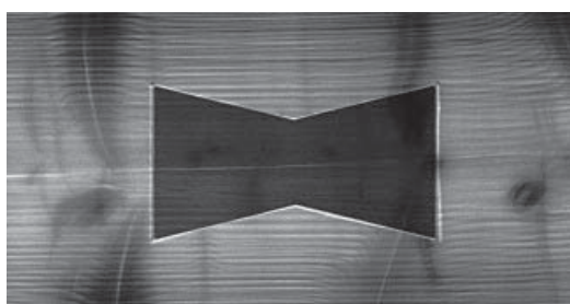
Röntgenaufnahme (Draufsicht/Seitenansicht) eines Dübelbalkens mit Hartholzdübel.
