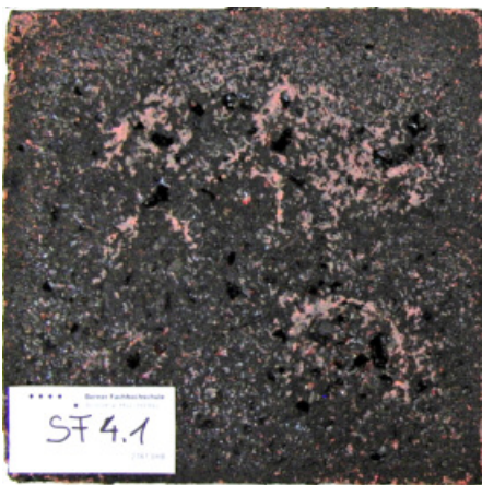
Geöffneter Prüfkörper mit Blasenbildung.
