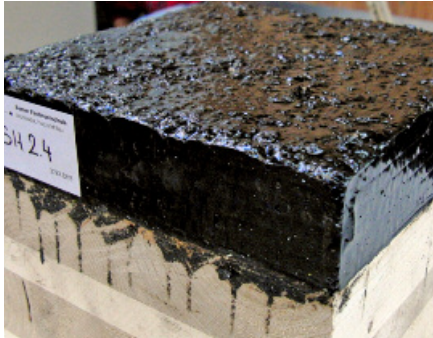
Prüfkörper auf einer Brettsperrholzfahrbahnplatte.
