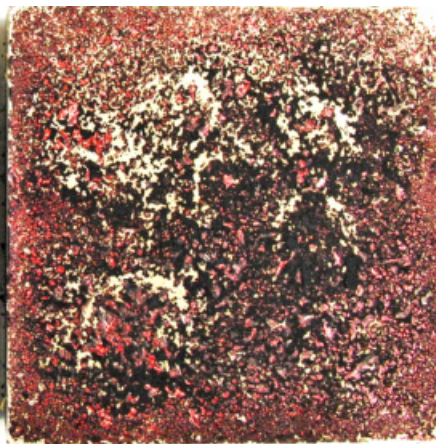
Prüfkörper mit sichtbarer Blasenbildung.
