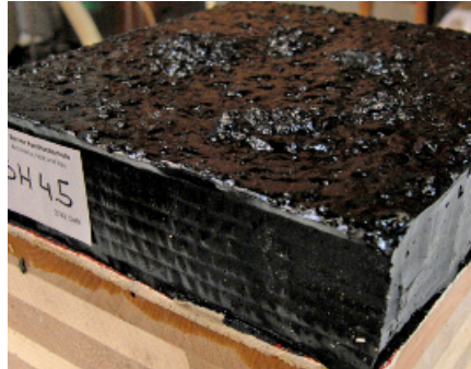
Prüfkörper mit sichtbarer Blasenbildung.
