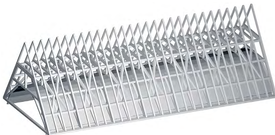
(9) Dreidimensionales Statikmodell eines historischen Dachtragwerks
