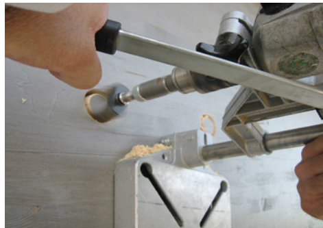
Abb. 2: Führung des Zapfenbohrers / Scheibenschneiders mit einem Bohrständler
